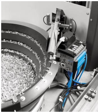
Figure 4.1 : bol vibrant de stockage et de tri de vis
